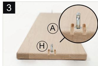
**(H) Schritt 1-3 WICHTIGER HINWEIS:** Schrauben Sie Halter H bis zum Anschlag manuell ein (nicht zu fest). Drehen Sie dann Halter H soweit wieder auf bis das Loch parallel mit Länge von Fuß A ist (Abb. 3). Halter H wird etwas locker sitzen, dies ist richtig und wird später durch Eindrehen von Teil G mit Schritt 6 fest verbunden. **WICHTIG:** Das gleiche Vorgehen gilt für Schritt 7 und 12.
